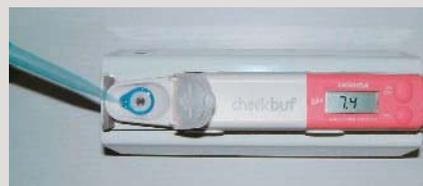
図10 唾液緩衝能の測定方法(1) 唾液を0.25mL滴下する。唾液のpHが表示される。
