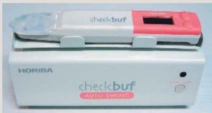
図9 唾液と酸をむらなく混和するための、振盪器。30秒で混和できる。
