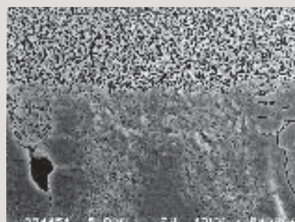
図5 トライエスボンドのヒト象牙質とのアルゴンイオンエッチングを施した接合界面の様相のSEM像（×10,000）、硬化したトライエスボンドには配合されている微小なフィラーがみられ、下半分の象牙質と緊密に接合していることが判るものの、これまでのボンディング材に見られたようなレジン-象牙質ハイブリッド層はみられない。
