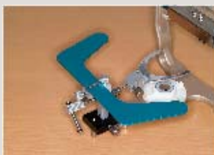
図13 エキステンション・ロッドを使わずにフォックス・プレートを直接取り付け付けた状態。
