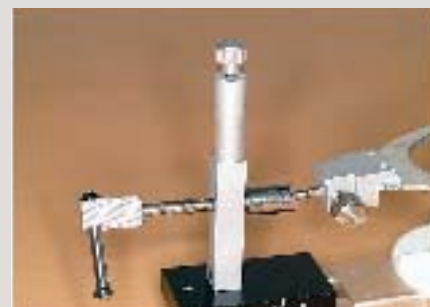
図11 垂直ロッドにエクステンション・ロッドを取り付けた状態。
