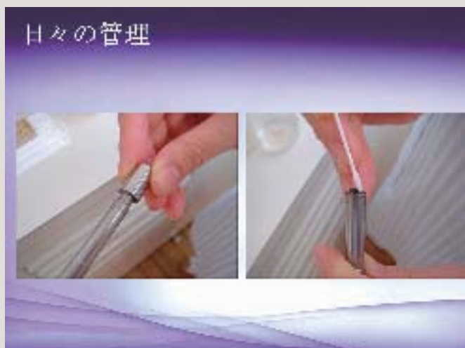
図11a Oリングへのグリス塗布とアルコールに浸した綿棒でのドラムレンズの清掃です。
