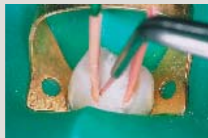
17 スプレッターを使用しないで、アクセサリポイントを挿入できるところまで押し込む。これを繰り返す。
