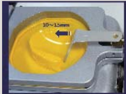
図29 模型を前方へ移動 テフロン製の調理用具などを用いて、シートの上から模型を前方にシートのたるみがなくなるまで10~15mm程前方へ移送します。
