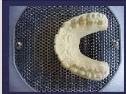
図26 成形台への模型のセット 模型後端を手前に向け、切歯乳頭部がシート中央になるようにセットします。
