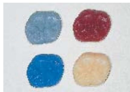
図12 各カラーのワックスを型に流し、視認性の確認。オペーク感が強調され、ワックスパターンの表面性状、視認性は高い。
