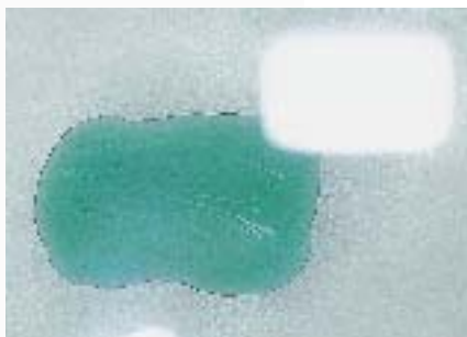
図5 裏から見た状態。はがれた所は見当たらない。
