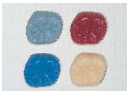
図16 ストーンハードワックスのワックスパターン。
