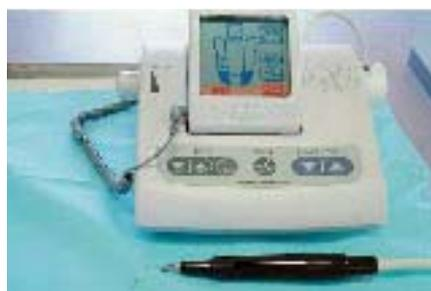
図7 ソルフィー-ZXにダイヤモンドファイルを装着した状態。
