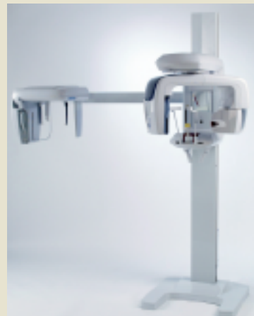
図5 通常のデジタルパントモ機（セファロ付）と変わらない大きさ、形態でCT撮影が可能である。
