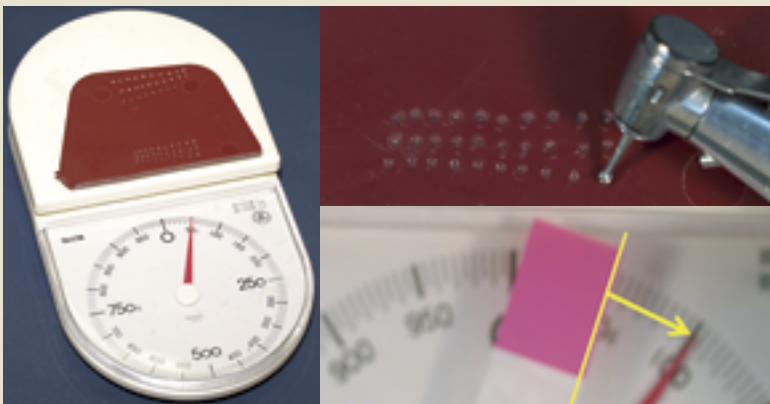
図3 切削能力の測定に用いた器具。 計量器に中性モデリングコンパウンドを固定し（左）、45°の角度でバーをあて、1,000rpm、荷重50gで5秒間切削した（右）。
