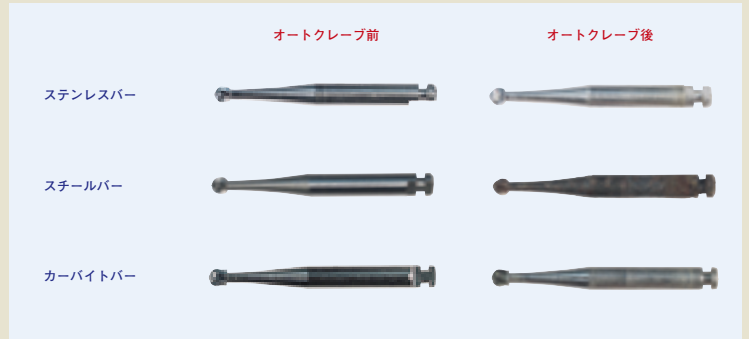
図2 各種マイクロモーター用ラウンドバー。 上から、ステンレスバー、スチールバー、そしてカーバイトバー。サイズはすべて#6。オートクレーブで数回滅菌後（右）、スチールバーは錆が出ている。カーバイトバーは表面が少し曇っているが、ステンレスバーに錆は見られない。
