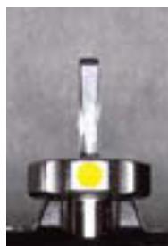
図4 隣接面用ライトプローブの黄色い点がある側では測定できない。
