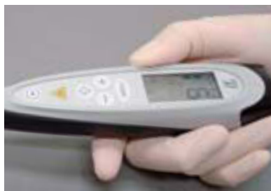
図14 キャリブレーションが成功すると、セラミックリファレンス番号がMOMENT PEAKに表示される
