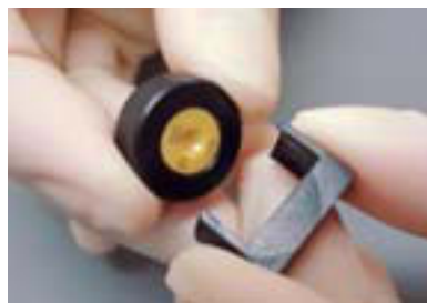
図13 隣接面用のライトプローブではセラミックリファレンスとアダプターを装着する。
