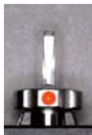
図5 隣接面用ライトプローブの赤い点のある側からレーザーが出て、測定可能である。
