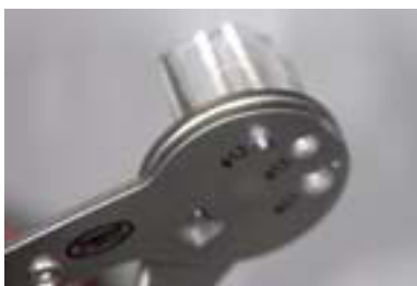
図28 ファイバーカッターはポケットが付いているためファイバーポストの汚染を防ぐことができる。
