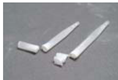
図29 ニッパーで切断したもの(右)とファイバーカッターで切断したもの(左)の比較。
