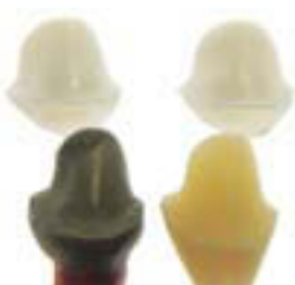
図1-1 カタナジルコニアコーピングを厚さ0.4mm、メタルコアとレジンコアを想定した支台歯に装着し比較した。コーピング装着前の写真。
