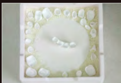
削りだされたジルコニアフレーム。
