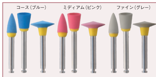
図9 仕上げ研磨用ポイントスターグロス CA (エデンタ社)。天然ダイヤモンドの粒子含有の仕上げ用ポイントで、コース、ミディアム、ファインの3ステップで滑沢な研磨面が得られ、研磨ペーストを使用せずに艶を出すことができる。
