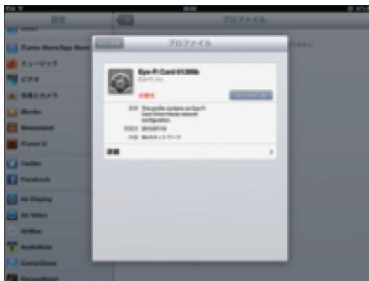
図15 アクティベーションコードに関連づけられているEye-Fiカードのプロファイル(ネットワーク名とパスワード)をiPadにインストールする。これにより接続が簡単になる。
