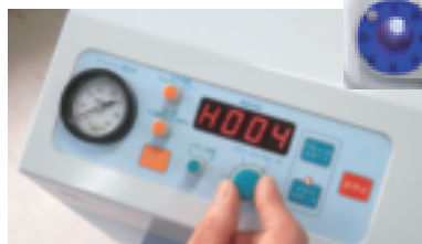
図21 必要に応じて加熱パワーの出力をパワーコントロールツマミで調整し、チャンバー上部の金属目視窓から融解状況を確認する。
