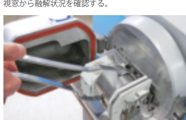
図24 チャンバー内の圧力が抜けたらチャンバーを開け铸造物を取り出し、铸造作業が終了となる。
