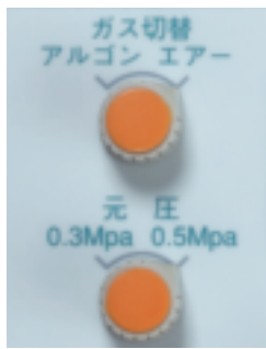
図10 上：ガス切替つまみ アルゴンガスを接続した後、エアーとアルゴンガスを簡単に切替ができ、铸造時に加圧する気体を選択することができる。下：元圧切替つまみ 铸造時にかける圧力(到達スピード)を選択する。
