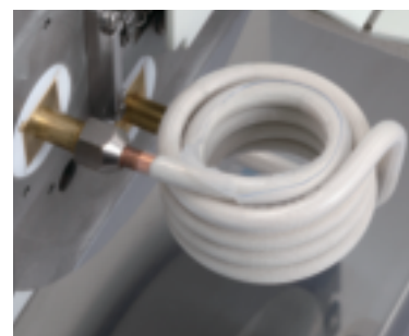
図2 加熱コイルを2重巻きにしており、ルツボ内の金属を高速での融解が可能である。
