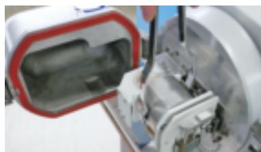
図18 チャンバーを開け、ルツボに歯科用合金を入れ、铸造用リングをセットする。
