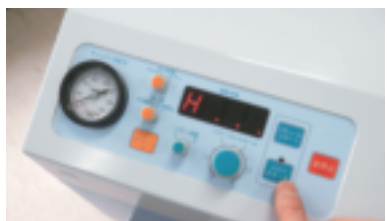
図20 減圧が完了したらメルトスタートキーを押す。
