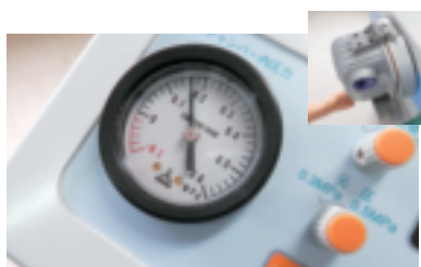
図23 チャンバーの回転と同時にチャンバー内に圧力がかかる。一定時間経過したらチャンバーを元の位置に戻すと圧力が抜ける。
