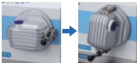
図15 手動によりチャンバーを回転させる。
