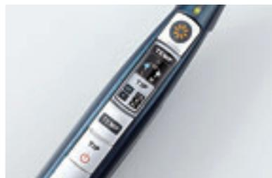
図7 ダイアペンの先端温度の設定。写真は筆者が使用しているモード。Fのチップを用いて、Low (170度) の設定となっている。
