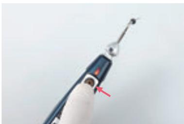
図4 ダイアペンの赤いボタン(矢印)を押すとチップの先端が設定温度まで上昇する。
