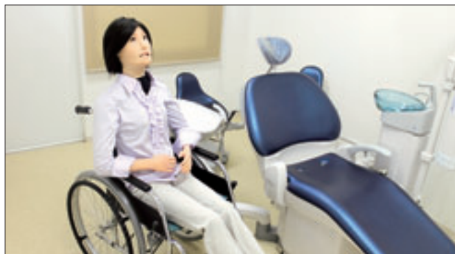
座位も水平も自在に。ロボット本体を取り外して、臨床実習用のユニットとしても活用できる。
