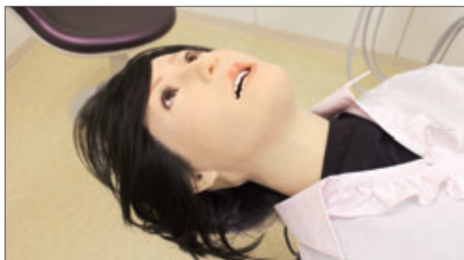
チェアユニットから供給される圧搾空気によって、口・まぶたの開閉、首・眼球の左右上下運動、左手の上下運動が滑らかに駆動。自然な発語ができるスピーカも内蔵。
