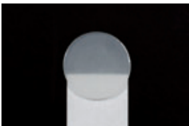
図17 E-グレースの焼成ペレット。ガラス様を呈しており、混ぜるステインの発色を阻害しないばかりか、リュウサイト結晶を含んでいるため強度的にも優れる。
