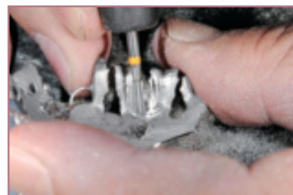
図12 カーバイドバーをメタルアップ部の面に沿わせ、均一に形成している一コマ。2度ほど撫でるだけで、カーボランダムポイントにはないシャープな面が得られている。筆者は、ミリングワークにも代用している。#1727使用。
