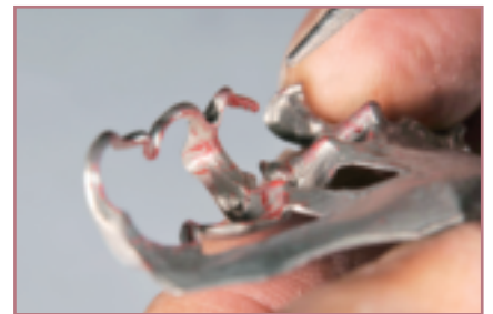
図3 “メタルデンチャーワークのポリッシングは、内面から”という言葉は定説である。クラスデンチャーの場合、鉤腕の先端は、アンダーカットを捉えているので印記されるのは当然である。むやみに削合しない。
