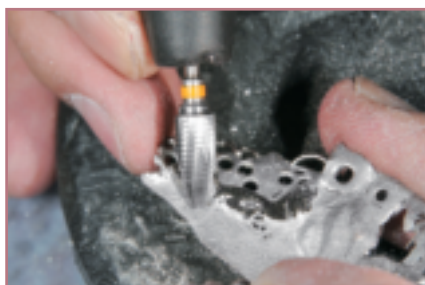
図11 高分子材料との境界となるフィニッシングラインの形成中の一コマ。硬いコバルトクロムアロイの粉塵が瞬時に拡散していることがお分かりであろう。#7227または#6927を使用。
