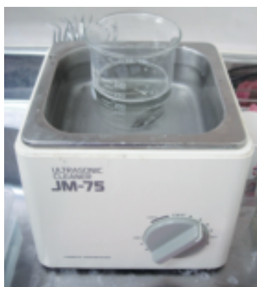
図2 バー類の超音波洗浄 ウルトラソニッククリーナー JM-75 ＜製造：（株）モリタ製作所＞
