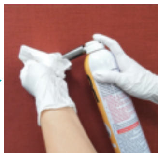
図6-3 ハンドピースの処理：注油 ARスプレー<販売：(株)モリタ製作所>
