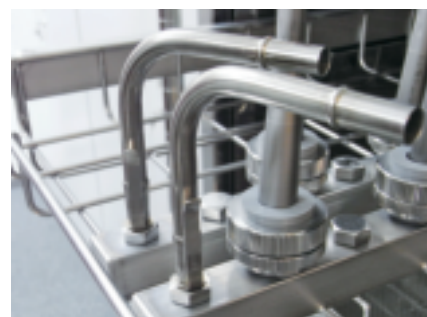
図5 ウォッシャーディスインフェクターのラックでバキュームチップを洗浄
