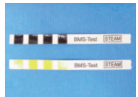
図9-3 蒸気が浸透すると黄色から黒色に変色する
