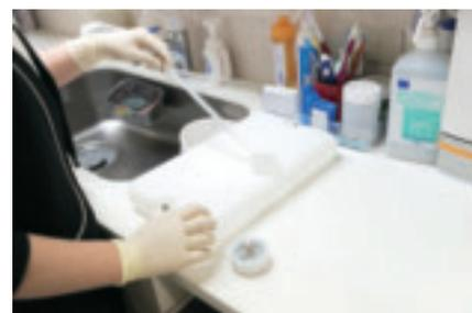
BC-17のカートリッジタンクに給水中。本体上部に収納されているので比較的簡単に給水できる。
