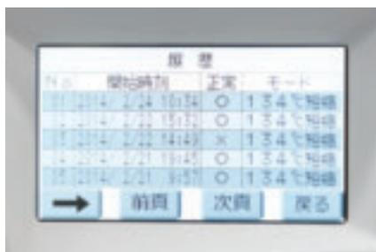
BC-17のパネル。過去の滅菌の履歴が一目で確認できる。途中で停止したりエラーが発生した場合にも記録が残る。
