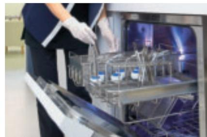
図4 洗浄するインスツルメントをセット。ハンドピースは専用のアダプターに収納し、内部まで洗浄する。
