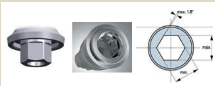
図1 アバットメントとの安定した結合のため、内部六角構造による嵌合様式を採用し、マイクロギャップは最大 $5\mu\text{m}$ 、回転方向のマイクロルーブメントの角度は最大で $1.8^\circ$  と高い適合精度を実現している。
