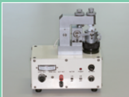
図4 オシレーティングレオメーター 歯科材料の硬化挙動を測定する装置である。
