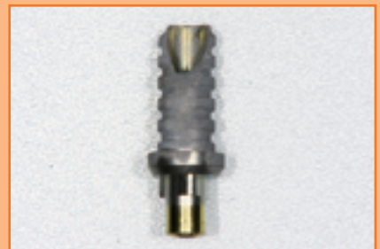
図15 アルミナサンドブラスト処理後、メタファストボンディングライナーを塗布、乾燥させる。
