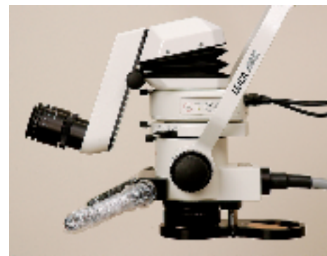
図13 当院では、マニー社「ライカM300」に「双眼可変鏡筒ウルトラロー」(オプション)を取り付けて使用している。必須アイテムの一つ。
