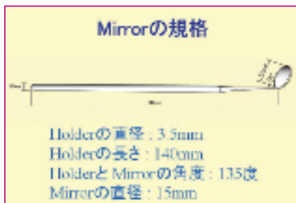
図12-1 pd条件に合ったミラーの規格。
