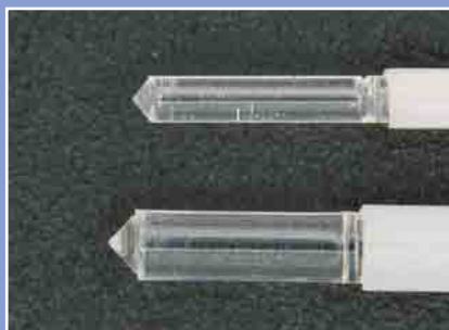
図14 P600T(下)はP400T(上)に比べ、太いので摩耗性とチップ強度が高くなっています。しかし、無理な動かかし方をすると先端が破損することがあります。
