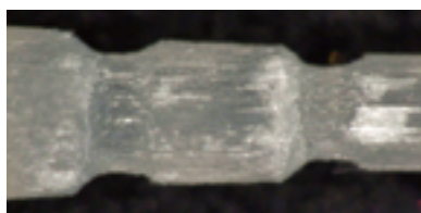
図7 溝を2本付与したポスト先端部の強拡大
