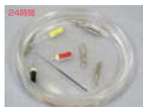
図7 ウルトラ・クレンジムによる錆の発生状況をスチールバー、ブローチ、リーマーを用いて試験した。この結果、泡埋24時間放置後、全てに錆の発生は認められなかった。
