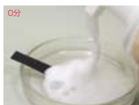
図5 泡埋法によるゼラチン皮膜の分離試験。ウルトラ・クレンジム50倍希釈液による泡により泡埋。泡の消失とともに皮膜3層が分解し、白色の下地が露出。
