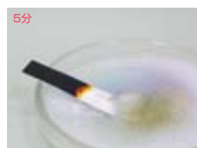
図5 泡埋法によるゼラチン皮膜の分離試験。ウルトラ・クレンジム50倍希釈液による泡により泡埋。泡の消失とともに皮膜3層が分解し、白色の下地が露出。
