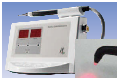
図3 従来のダイアグノデント(DIAGNOdent)と咬合面用プローブ。隣接面用プローブの登場が待望されて久しかった。
