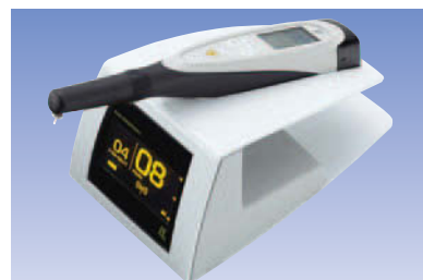
図4a ダイアグノデントペンとディスプレイ部(ディスプレイ部とは分けて使用できる)
