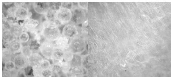
図15 プロビスタのポリマー粒子(左側)と研磨面(右側)＜光学顕微鏡像×500倍＞。
