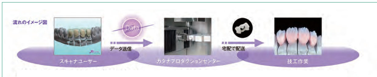
図7 カタナジルコニアフレーム製作手順。自身でスキャンからデザインを行うことで、思い通りのデザインが行える。デザインデータをプロダクションセンターへ送信することで、最短、中2日で、ジルコニアフレームを手にすることができる。
