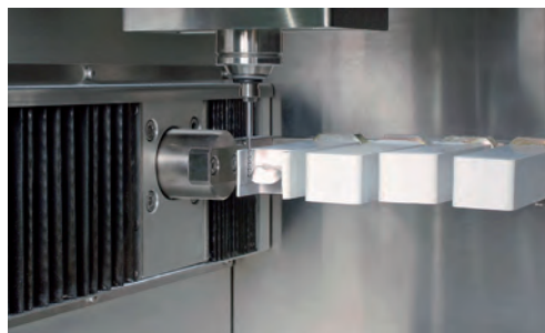
図4 小型卓上加工機：「ノリタケカタナH-18」4本のジルコニアブロックを連続切削可能。
