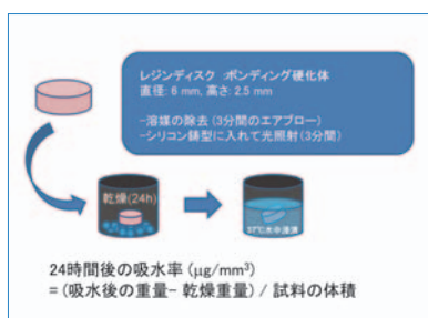
図7 接着材の吸水性試験法
