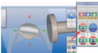
図11 デザインツール。画面右下のデザインツールによりDrの好みに応じたシェード効果を設定可能。上下左右移動と歯軸を中心とした近遠心方向の回転や、近遠心軸を中心とした回転が可能。
