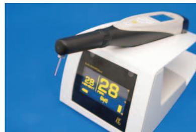
図3 ダイアグノデントペンとそのディスプレイ。測定値 (モメント値、ピーク値) を本体とは離れたディスプレイで確認することができる。ペリオプローブを使用した場合も使用できる。
