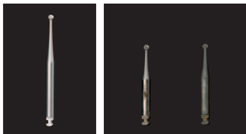
図7 歯周外科用根面バー（左）とスチールバー（右）水に浸漬してもステンレスバーは錆びにくい（水道水に24時間浸漬後）
