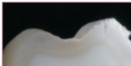
図7 二酸化リチウムをコア材として、外側にセラミックを焼成したクラウンを切断してみた。焼成時に重力の影響を受けて、咬頭寄りに沢山の気泡が存在することがよく判る。これもトランスイルミネーターのLEDのライトでないと発見しにくい。
