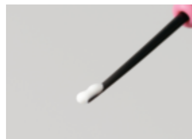
図17 エンドノズルからシーラーが押し出される様子
