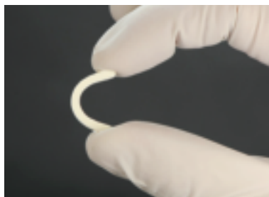
図7 シーラーの硬化体を指で曲げた様子
