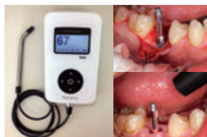
図1 オステルISQアナライザ。外科処置時でも治療期間中でも計測が可能。
