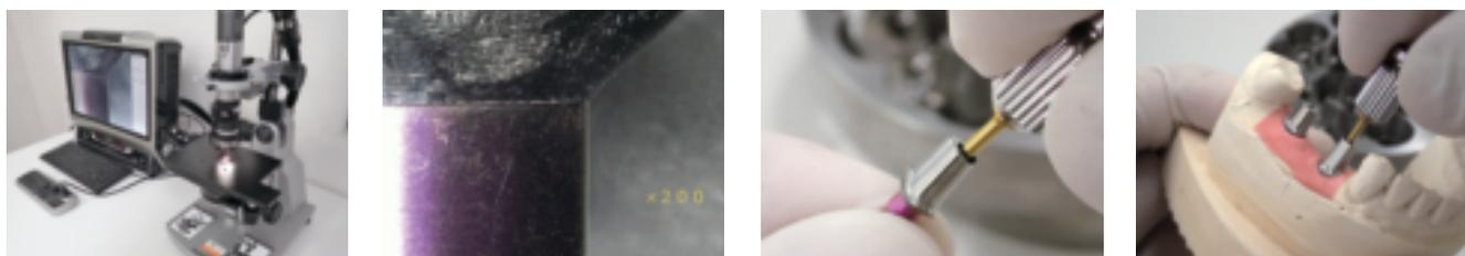
㉓～㉕電子顕微鏡を用い、接合部の嵌合状態、アクセスホール内部の加工状態を確認する。KPC所有のインプラントレプリカ上での適合、お預かりした模型上での適合を確認し、さらに、各社より販売されている純正スクリーを用いた締結確認作業を行う。カタナ チタンアバットメントでは、対インプラントフィクスチャーをメインに設計されているためインプラントレプリカ上での適合感とフィクスチャー上での適合感において僅かな差が見られるが、口腔内での適合感を重視し、製作している。
