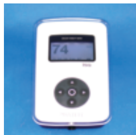
図1 オステルISQアナライザの本体。ISQ値が1~100の数値で表示される。
