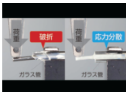
図1 ガラス管を歯根と見立て、左が既製金属ポスト、右がグラスファイバーポストを使用した時のイメージ。左はガラス管(=歯根)の破折が認められる(サンメディカル提供)。
