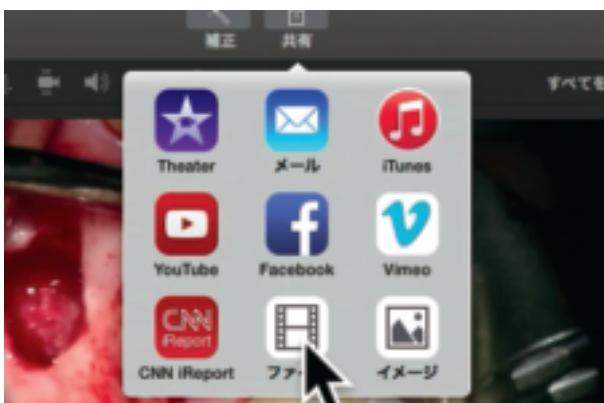
図31 編集が完了した一連のタイムラインを一本のファイルとして出力する。【共有】ボタンをクリックし【ファイル】を選択、指定した場所に動画ファイルを保存する。なお解像度は【1280×720】、品質は【高】で十分である。
