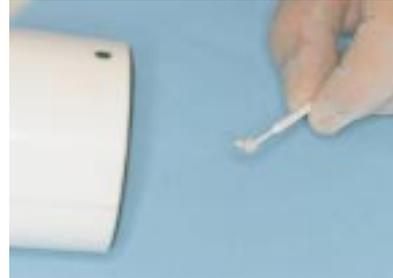
図39 シランカップリング剤は熱でより活性化する。ドライヤーを使用。
