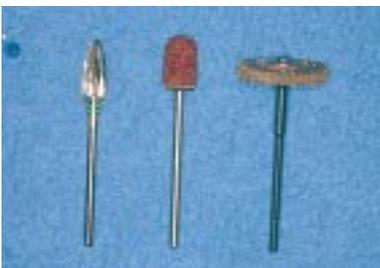
図20 付属の研磨用バー。形態修正は、左のバーより順に行う。
