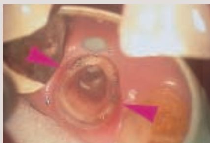
図12 実体顕微鏡下で破折線(矢頭)を確認。
