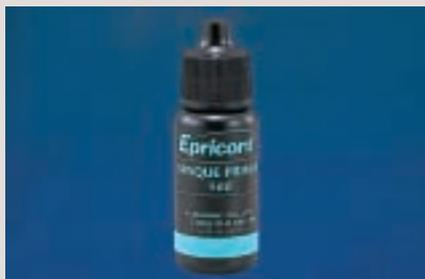
図8 オペークプライマー。金属接着性を有するリン酸エステル系モノマーを含有し、オペークと接触すると化学重合してオペークの硬化を確実なものとする。
