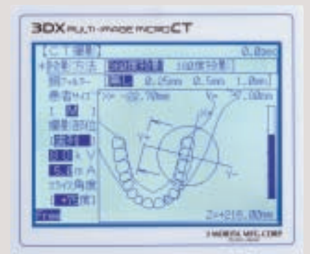
図4 液晶画面 イラストで示される歯列と円型の撮影領域によって、診断部位を確認する。図3のライトビームと併用することで、正確な位置合わせが可能となる。
