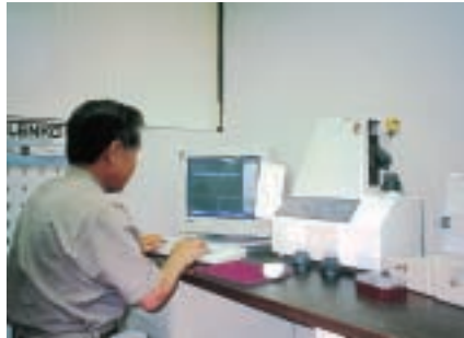
図1 スキャナーのホルダーにダイを固定し、レーザー光線を照射してダイの角度を定める。
